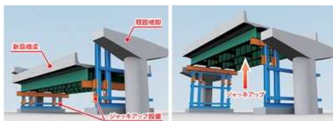
図-2 ジャッキアップ架設工法の概要
