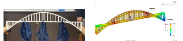
(a) 荷重試験の様子 (b) 静的解析による変位予測 図4 橋梁模型製作の最終成果の一例
