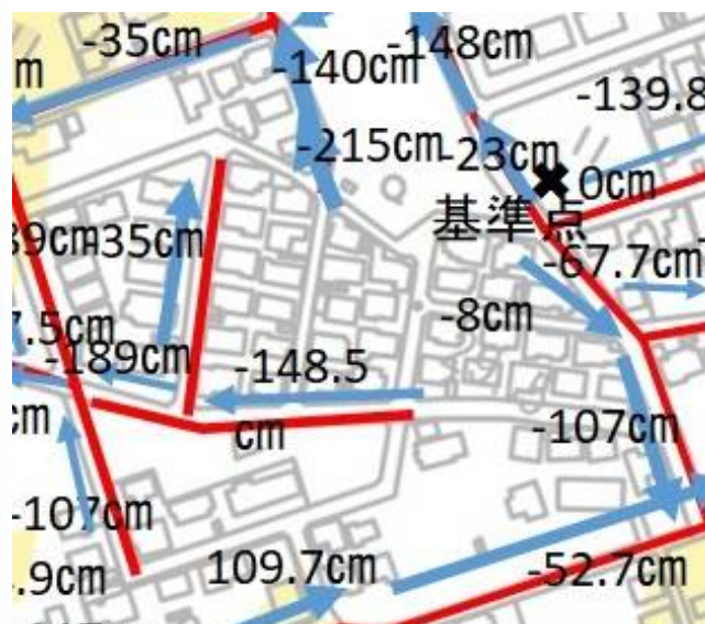
図4 内水ハザードマップに展開した高低差表示 (ひたちなか市はしかべ地区)
