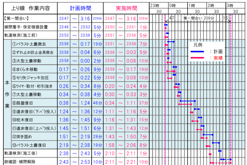
図-4 引抜き撤去タイムスケジュール実績
