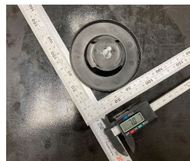
図5 剥がれ量の計測状況
