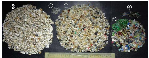
写真3 MPの素材構成(K34伊勢町海岸)の事例 ①レジンペレット(2タイプのサイズ)、②プラスチック微細片 ③発泡スチロール微細片、④糸状合成繊維短片、⑤その他(省略)
