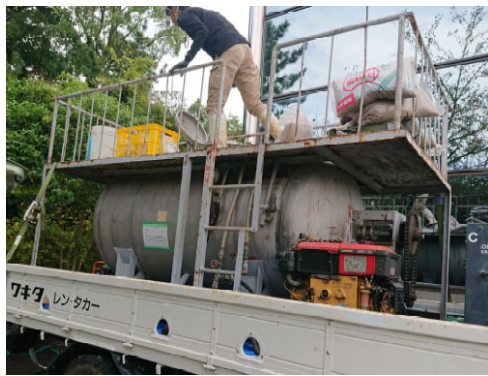
図-1 吹付け工に使用したエアロシーダー
