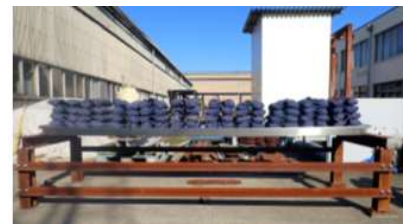
写真-2 試験状況（耐風圧試験）
