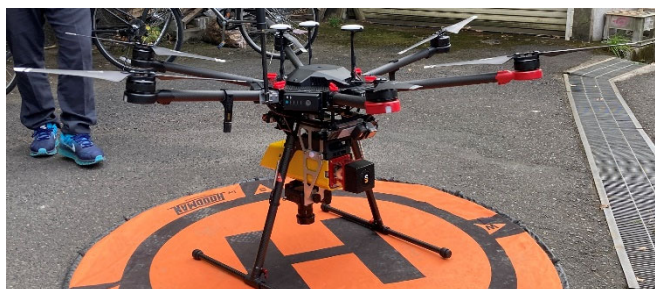
写真-2 実際に使用した UAV とレーザースキャナ
