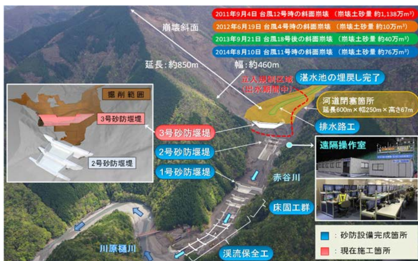
図-1 赤谷地区対策工事全体概要図
