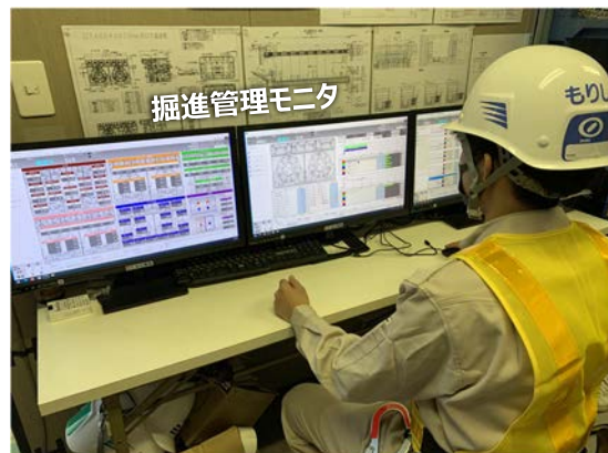
写真 2 掘進管理システム
