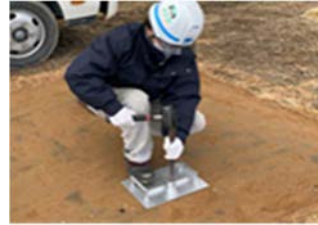
写真-1 (左)鉄ピン打込み状況 (右)測定器 (ANDES) での計測
