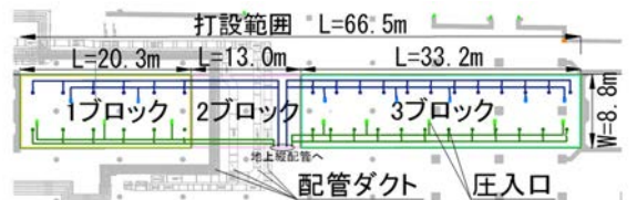
図-2 打設箇所・配管ルート図
