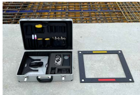
図-7. デジタル配筋検査機材例
