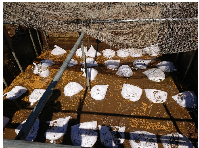
図 3 沈砂池に火山灰質酸性土に入った土のう袋を投入した様子
