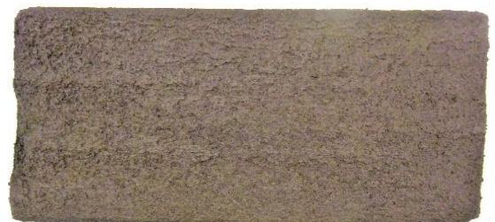
写真-1 凍結融解 450 サイクル供試体
