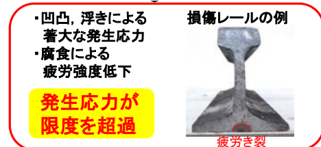
図6 当該レール損傷の発生メカニズム
