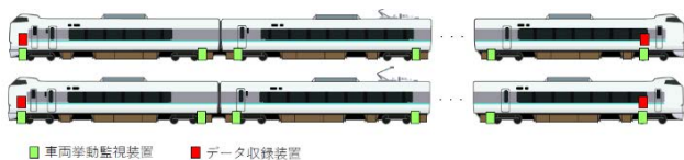
図1 車両挙動監視装置等の設置状況
