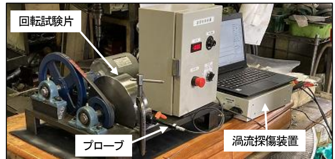
図2 渦流探傷の速度対応試験の状況
