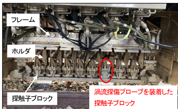
図4 渦流探傷プローブの搭載状況
