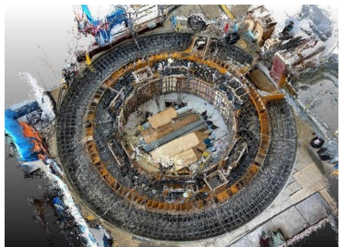
図-7 撮影したデータから生成した点群（1F 部） たドローンの自動飛行および安定したデータ取得方法の確立に向け取り組んでいく。
