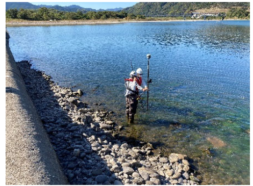
図-4 VRS-GNSS計測状況
