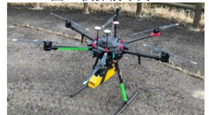
図-2: レーザースキャナ搭載 UAV
