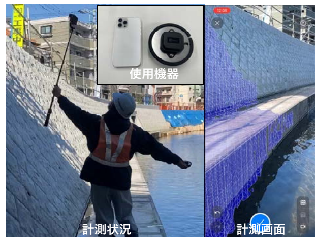
図2 モデル工事で使用したモバイル端末計測技術
