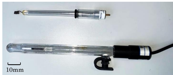
写真1 塩分センサ(上)と基準電極(下)
