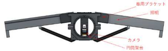
図-4 撮影ユニットの構造
