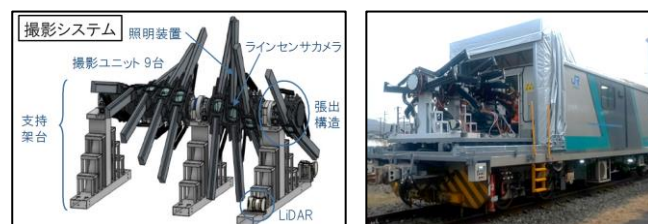
図-2 次世代 SATUZO 撮影システムの構成及び搭載状況
