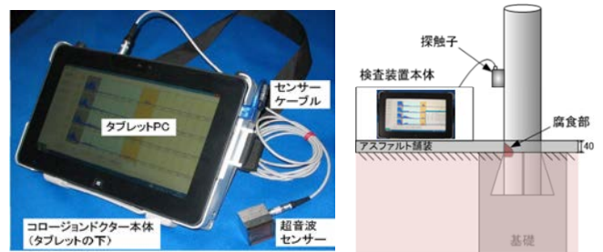
図-1 検証機器及び調査イメージ（超音波調査）
