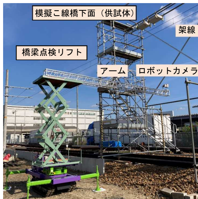
図-3 模擬線路での性能確認
