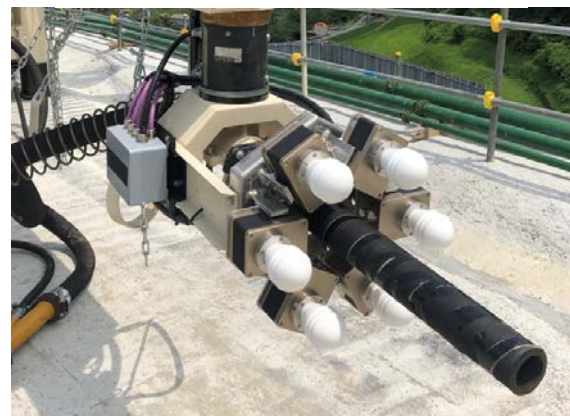
図-6 ミリ波レーダーシステム
