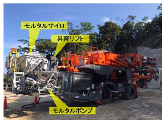
図-3 モルタル供給装置の一体化
