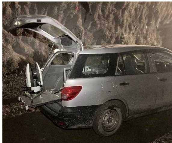
写真-2 車に搭載したレーザートラッカー
