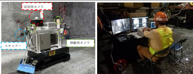
写真-1 スキャナー搭載カメラ台車
