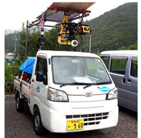
図-2 車載型切羽監視レーダー
