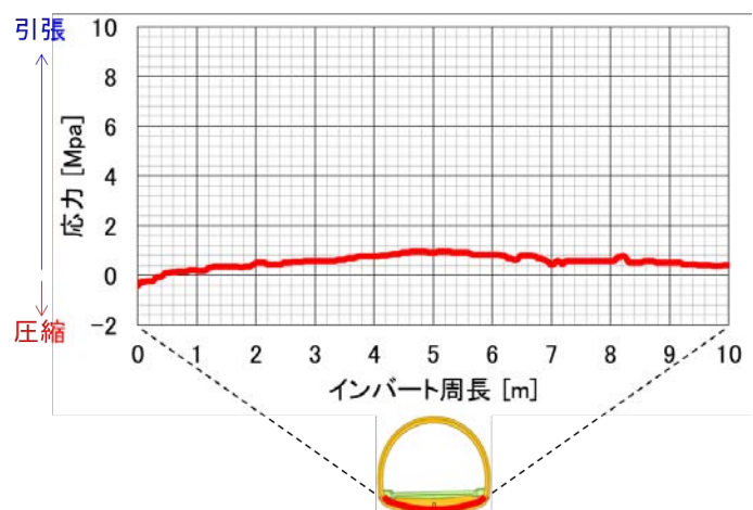
図-4 応力分布結果 (インバート)
