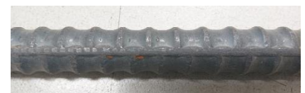
図-1 異形棒鋼ロックボルト
