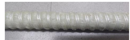
図-2 GFRP ロックボルト
