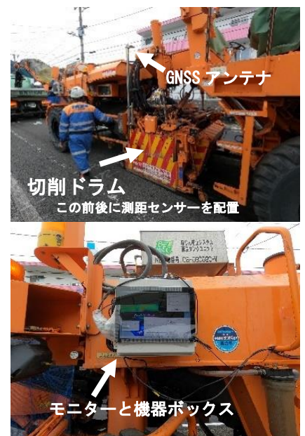
写真1 機器設置の様子
