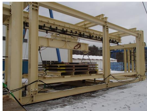
図-2 製作した架台と吊荷
