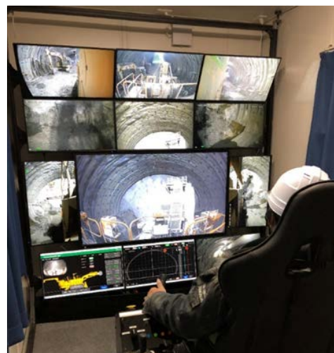
図-3 遠隔操作コクピット・モニター
