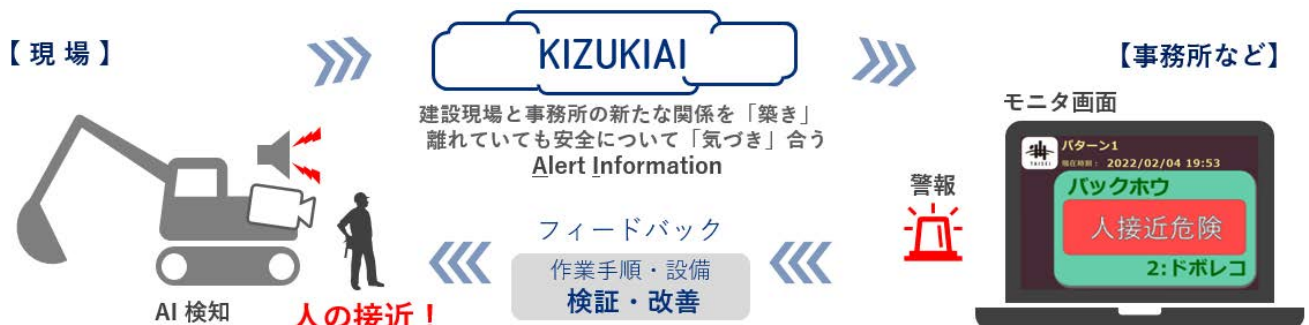
図-1 遠隔安全管理アプリ KIZUKIAI の概念図
