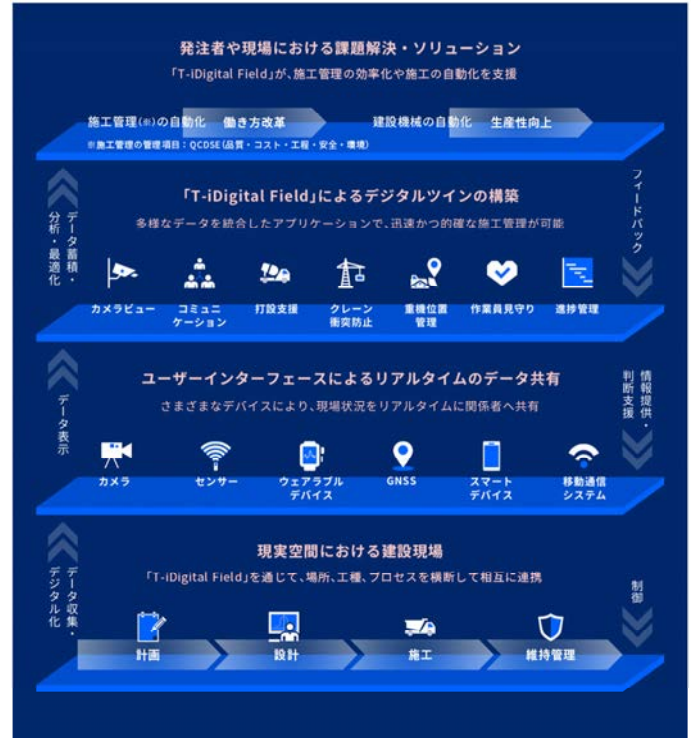
図-2 T-iDigital Field アーキテクチャ
