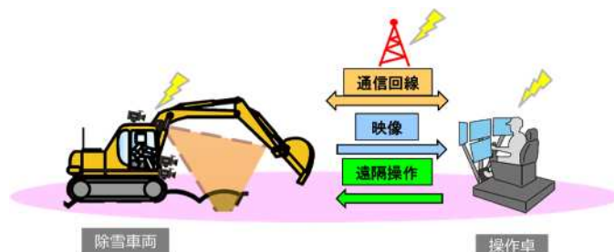
図-1 遠隔操作のしくみ
