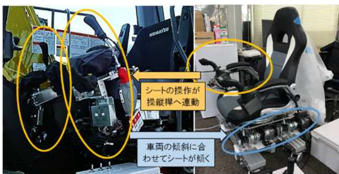
図-5 振動シートと除雪車の動作が連動するしくみ
