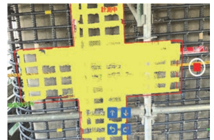
写真-2 計測範囲と点群データ
