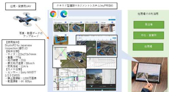
図-2 UAV 及び建設マネジメントシステムの概要
