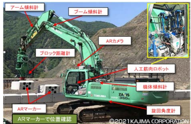
図-5 自動化施工仕様バックホウ概要図
