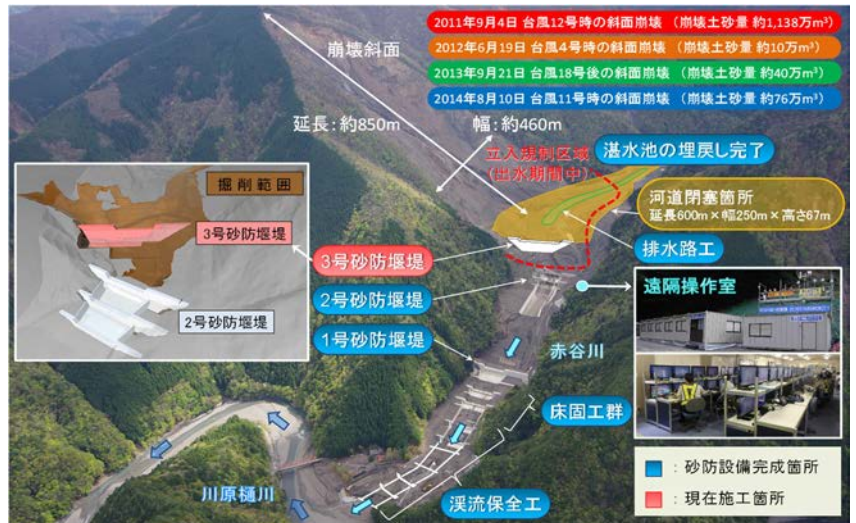
図-1 赤谷地区対策工事全体概要図
