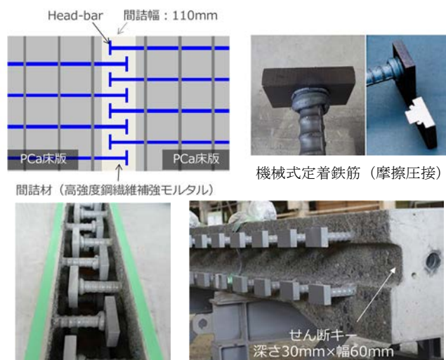
図-1 開発した PCa 床版接合構造
