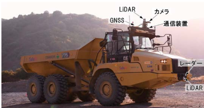
写真-1 自律化キットを搭載した ADT
