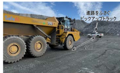
写真-2 障害物を検知して停止する様子
