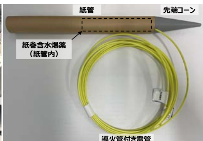
写真-5 自動装薬システム構成（③，④）
