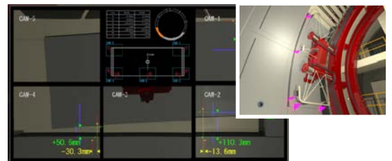
図-4 目違い目開き計測イメージ図
