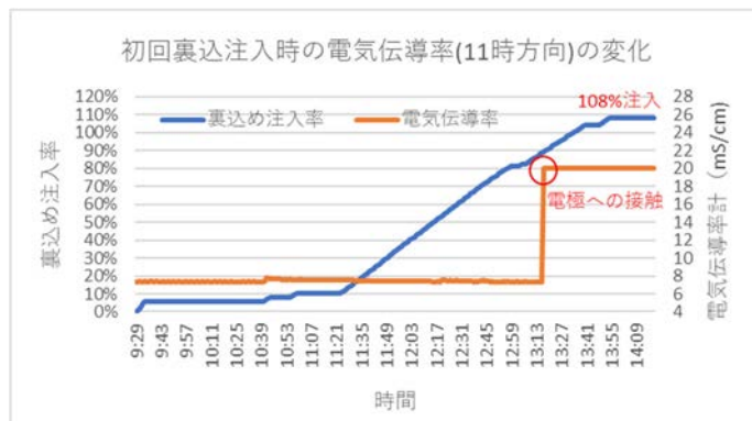
図-4 裏込め注入率と電気伝導率の計測結果
