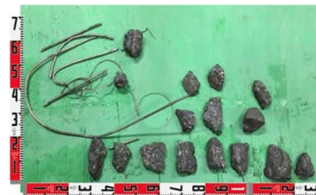
写真-1 不明障害物切削物
