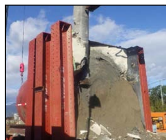
図-7 模擬杭状況(実験後)
